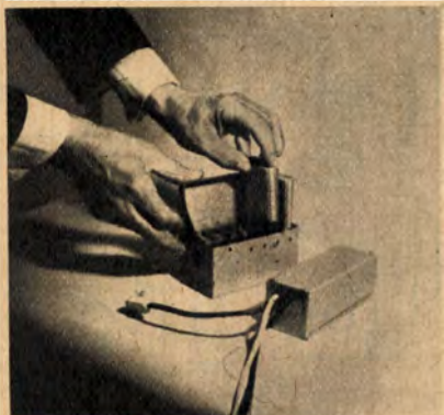
2. kép. Tranzverter és kondenzátordoboz az összekötő kábelkkel. A zseblámpaelemeket a rugós érintkezőkre helyezzük
